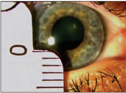
図 33: Graticule を用いてのレンズのセグメント高さの測定
